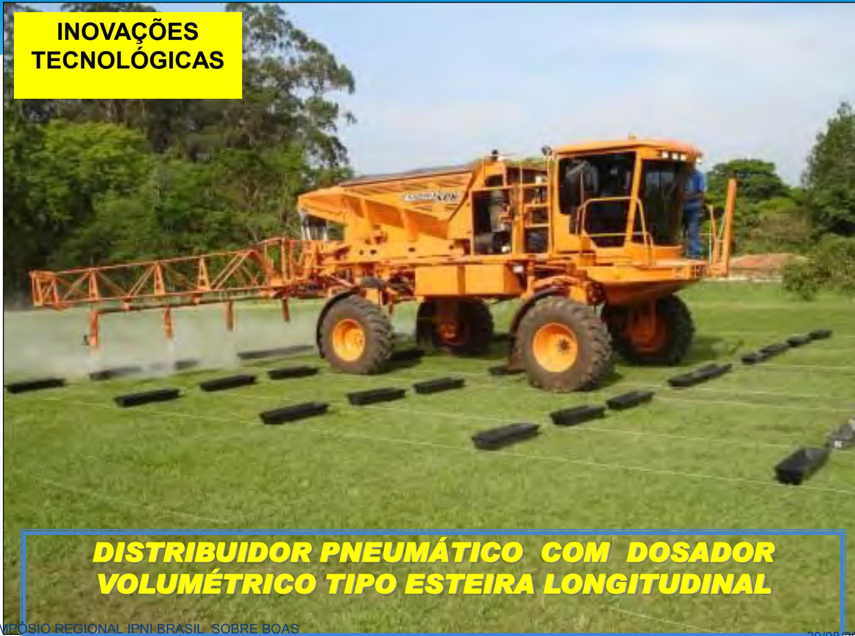
***DISTRIBUIDOR PNEUMÁTICO COM DOSADOR
