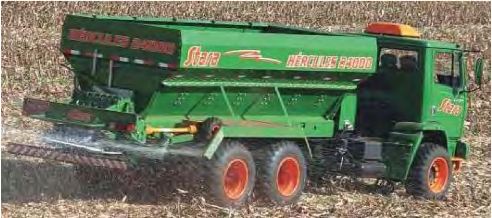
**CENTRÍFUGO COM DOIS DISCOS COM DOSADOR
