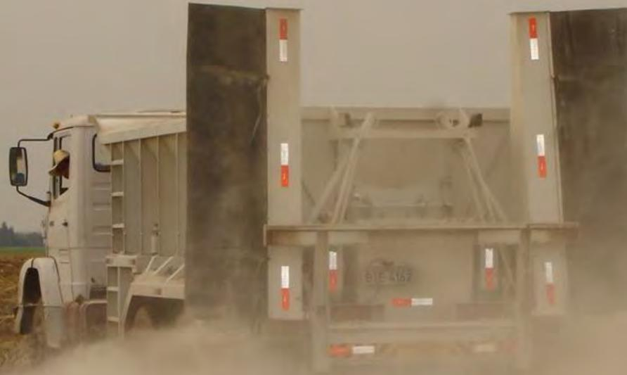
**DISTRIBUIDOR CENTRÍFUGO COM 2 DISCOS
