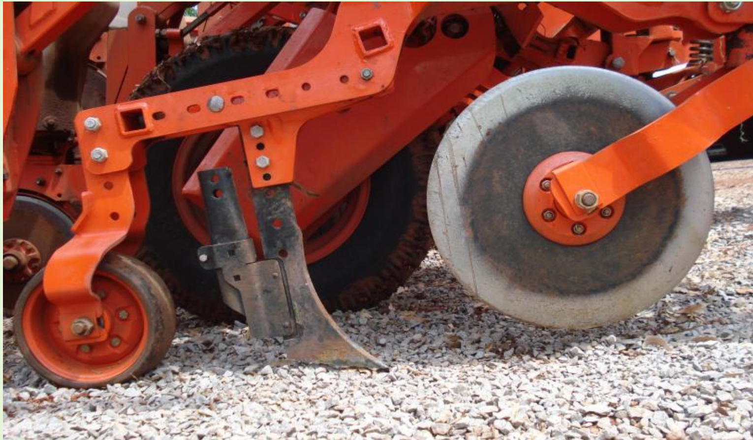
Semeadora para plantio direto com sistema de discos (modelo mais tradicional)
