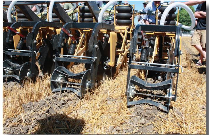
**Figura 3.** Inovação e adaptação regulares são necessárias para garantir que as práticas conservacionistas complementem e aprimorem os sistemas de manejo existentes. Este implemento foi projetado para aplicar o fósforo em faixas sob a superfície do solo; neste caso, sob a palhada de trigo de inverno, no outono.
